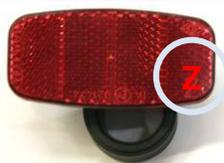
Ebenfalls müssen Fahrräder an der Rückseite mit einem roten Großflächenrückstrahler ausgerüstet sein, der mit dem Buchstaben „Z“ gekennzeichnet ist.
