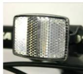
Nach vorne müssen Fahrräder ebenfalls mit einem weißen Front- bzw. Rückstrahler ausgerüstet sein.
