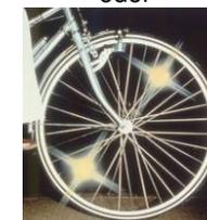
In den Speichen des Vorder- und Hinterrades sind längsseitig mindestens zwei seitlich wirkende Speichenrückstrahler anzubringen. Dies müssen um 180° versetzt montiert werden.
