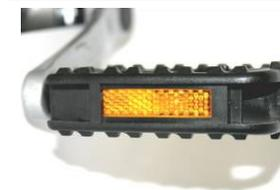
Fahrradpedale müssen mit nach vorn und nach hinten strahlenden gelben Rückstrahlern ausgerüstet sein. Nach der Seite strahlende gelbe Rückstrahler an den Pedalen sind zulässig.
